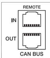
Jeder Verstärker hat zwei RJ-45 Buchsen für den Remote CAN-Bus. Die Buchsen sind parallel geschaltet und dienen als Eingang und zum Weiter-schleifen des Remote-Netzwerkes. Zur Verkabelung im Rack können handelsübliche RJ-45 Netzwerkkabel verwendet werden. Der CAN-Bus benötigt an beiden Enden einen Abschluss-Stecker mit 120 Ohm Abschlusswiderstand. Ausführliche Richtlinien zur Verdrahtung und Buslänge finden Sie im Kapitel „REMOTE CONTROL NETZWERK“.
